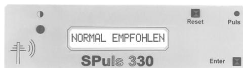
Betätigen sie jetzt die reset - Taste. Diese Taste wird normalerweise nicht betätigt und ist deshalb versenkt.
